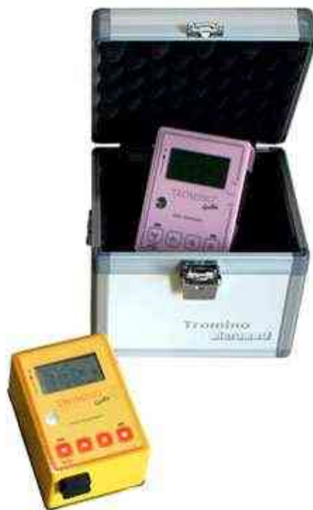
Figura 3 – Trometro digitale utilizzato per la prova HVSR
